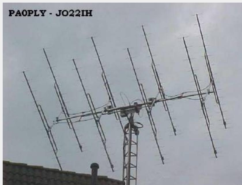
Photo 1.: Large EME array for 432MHz.
